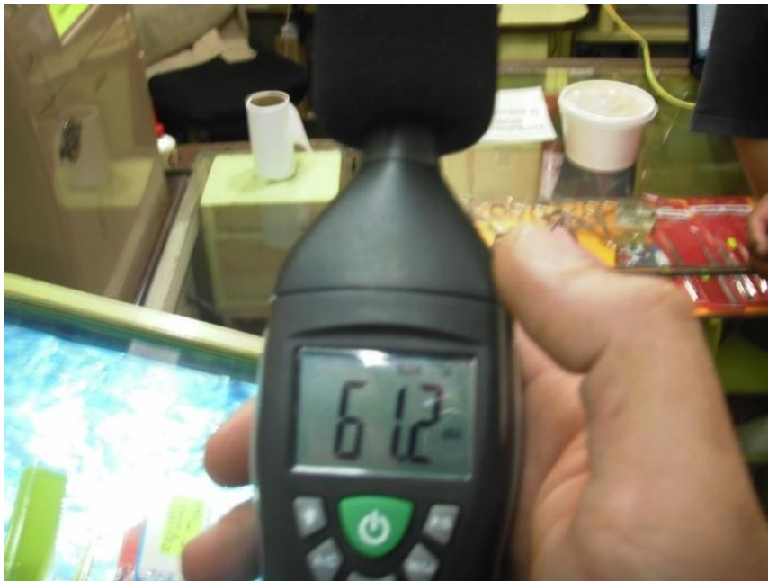
Sonómetro para medir la contaminación por ruido en decibeles
